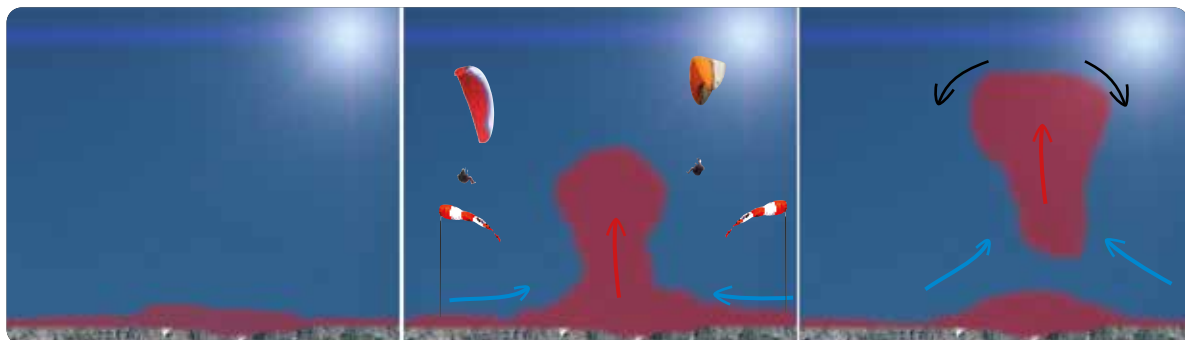
Рис. 1.3 Образование восходящего потока. Какой-то участок земли нагревается быстрее, чем окружающая его поверхность. Слой воздуха, лежащий на нем, нагревается как на сковороде, увеличивается в объеме и когда воздух уже больше не может удерживаться на поверхности земли, он поднимается вверх. Оба пилота на рисунке в центре летят по ветру.
