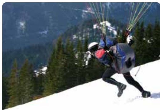
Рис.1.7 Сильный наклон вперед для быстрого разбега при слабом ветре. При ветре в спину стартовать нельзя.
